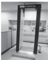
桑野協立病院の玄関に設置されているファスト・トラック・ファイバー(F.T.F)体内、体表面の放射線量を測定
